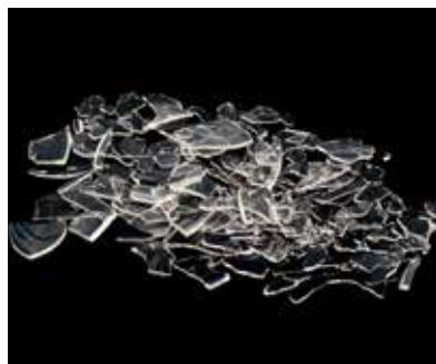
Silicasol: heeft een broze, gemakkelijk breekbare bindmiddelfilm en kan niet worden aangebracht als afdichtingslaag.
