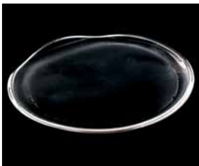
Kaliumsilicaat in vloeibare vorm. Dit is een beproefd bindmiddel voor silicaatverven.
